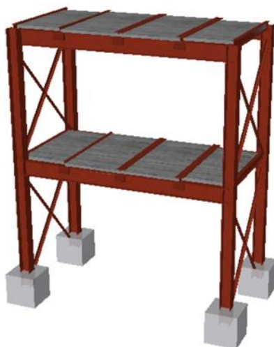
Фигура 6.22 – 3D модел на тестовата конструкция с възли с отслабено сечение на гредата
