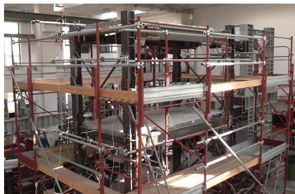
b) Тестов образец със съединения FREEDAM
