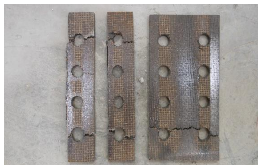
Фигура 2.15 – Крехко разрушение по отслабено сечение на каучуковите фрикционни подложки [43]
