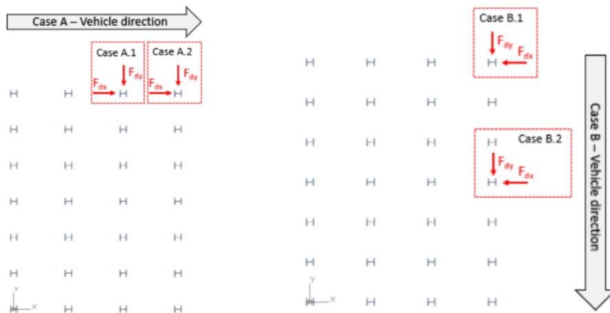
Figure 63. Vue en plan de la disposition des colonnes, des voies de circulation et de la position des colonnes sujettes à l'impact.
